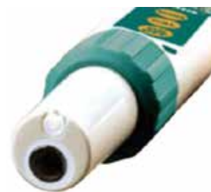
El electrodo con extremo plano funciona en líquidos, semisólidos y sólidos
