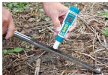
SoilStik se muestra en uso con la unidad 6510 Muestreador de suelo, Modelo HC (está disponible en línea)
