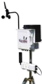
Instalación de Módem DataScout 3923 con Estacion WatchDog Serie 2000 full
