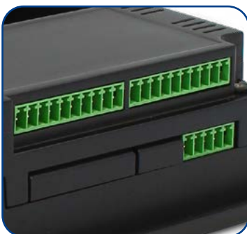
I/O analógicas y digitales integradas e interfaz RS485
